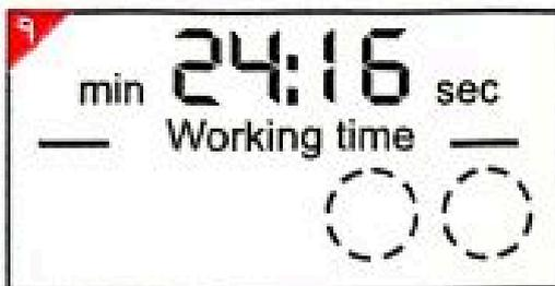
در حالتی که دستگاه به پریز برق متصل است ولی موتور خاموش می باشد، با ۳ ثانیه فشرده نگه داشتن کلید on/off، زمان کارکرد محصول صفر می گردد. همچنین در صورت کشیدن دو شاخه از پریز برق نیز زمان کارکرد محصول صفر خواهد شد.
