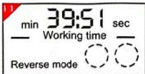
بعد از ۵ ثانیه کارکرد موتور در حالت برگردان، موتور بصورت خودکار خاموش می گردد و آخرین زمان کارکرد روی نمایشگر نمایان خواهد شد. (شکل ۱۱)
